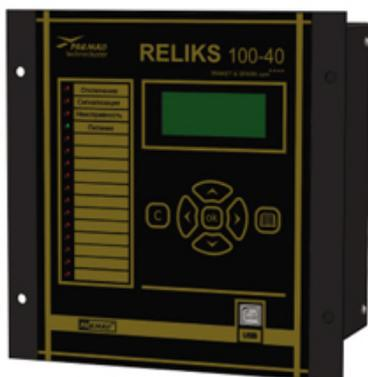
Микропроцессорные устройства защиты PREMKO RELIKS 100-40 предназначены для обеспечения функций релейной защиты и автоматики кабельных и воздушных линий, сборных шин, электродвигателей, трансформаторов (в качестве резервной защиты). Устройства могут быть использованы в схемах РЗА электрических присоединений среднего класса напряжения 6(10)/35 кВ на электрических подстанциях, распределительных пунктах, в ячейках КРУ/КСО.
