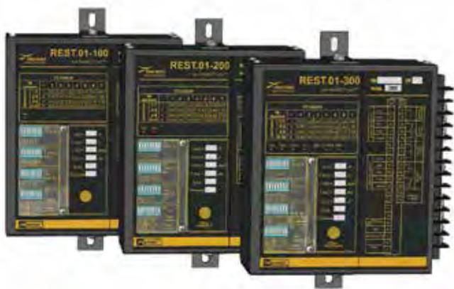
Микропроцессорные программируемые устройства серии **PREMKO REST.01** предназначены для реализации функций релейной защиты и автоматики кабельных и воздушных линий, сборных шин, электродвигателей, трансформаторов (в качестве резервной защиты). Устройства используются в схемах РЗА электрических присоединений среднего класса напряжений (6/10/35 кВ) на электрических подстанциях, распределительных пунктах, в ячейках КРУ/КСО.
